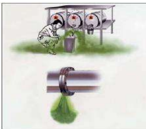
1 pav. Tipiniai nuotekų šaltiniai, kurie turi įtakos potencialiai sprogiai aplinkai susidaryti.
